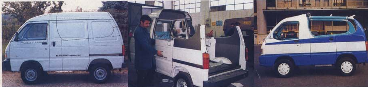
■ Tre diversi momenti del processo di trasformazione in "cabrio" di un Piaggio Transporter.
